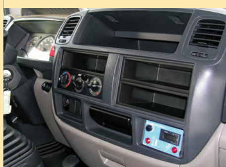
Indicateur de sortie de stabilisateurs en cabine
