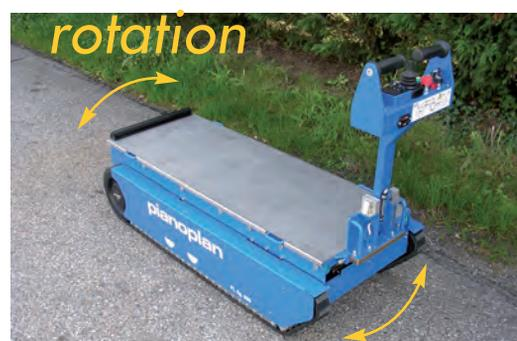
**Rotation** grâce à sa double motorisation, le Pianoplan tourne sur lui-même sur ses chenilles. De plus, cette fonction permet de rectifier la trajectoire, notamment dans les escaliers, en toute sécurité.
