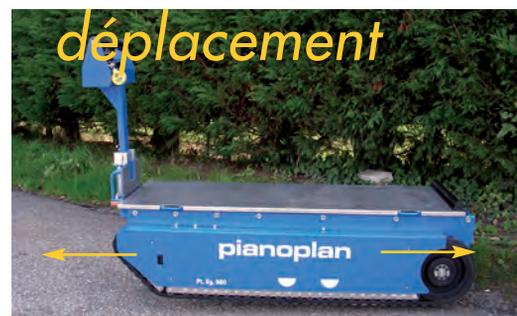
**Déplacement** sur chenilles (double motorisation électrique), à deux vitesses (lente et rapide) pour le passage d'obstacles, le franchissement de dénivellés ou d'escaliers, et l'évolution sur tous terrains.
